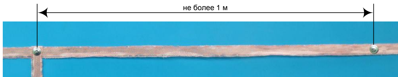
Рис. 15. Прокладка ленты основания.
