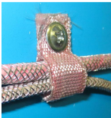
Рис. 5. Установка дюбель–хомута КФСТ.735322.041 и КФСТ.735322.164. Вариант 1.
